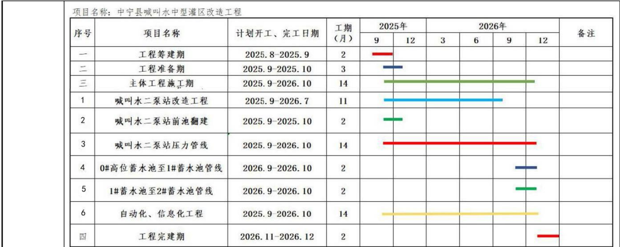
图2-6 本工程施工进度计划横道图
