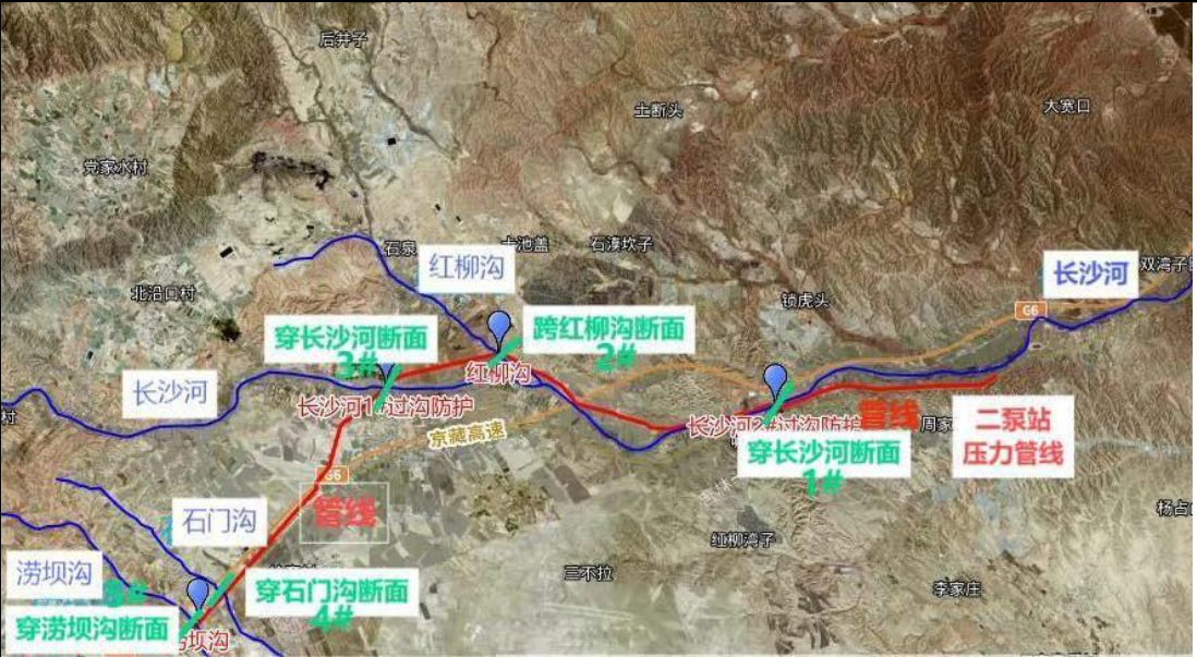
图2-2 管线和穿跨越的沟道位置关系图
