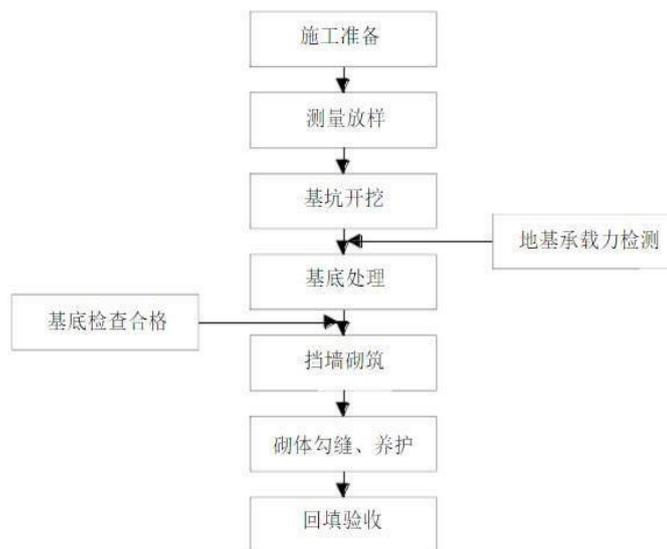
图2-7 浆砌石施工工艺流程
