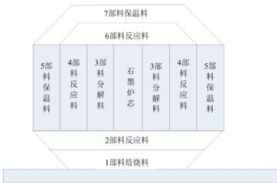
图 2-1 碳化硅冶炼炉装炉步骤示意图
